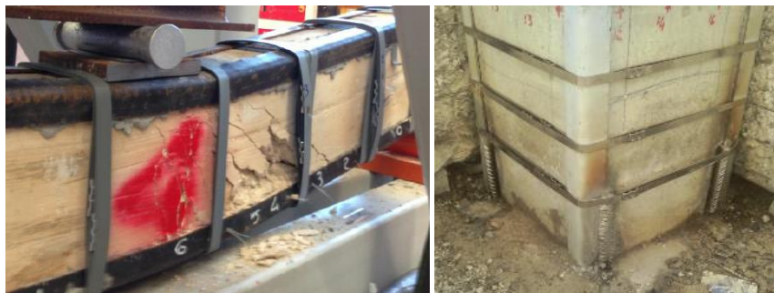
Figure 21. La sperimentazione svolta [14] sulle travi in CA e l'intervento di continuità d'armatura nei pilastri
